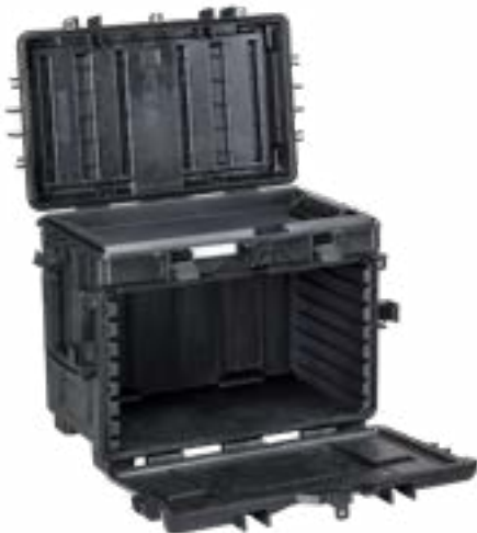
5140.BKTE.AH Vuota - predisposizione per cassetti Le guide laterali possono ospitare fino a 8 AIDRAW per un massimo di 10 diverse configurazioni standard (pag. 21 e 22). Configurazioni miste di cassetti vuoti e cassetti con spugna precubettata su richiesta.
